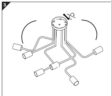
Alinhe as hastas da luminária para que fique conforme a imagem ao lado e aperte os parafusos na base.
