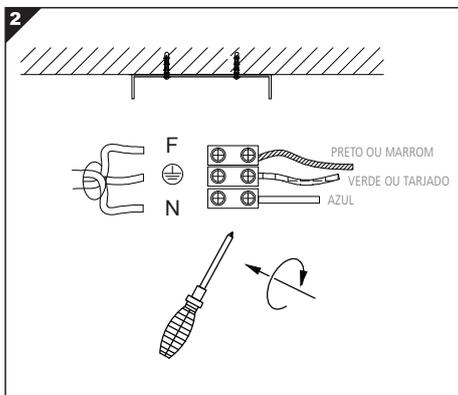
Conecte os fios de alimentação (F e N) e aterramento (≡) aos da rede elétrica.
